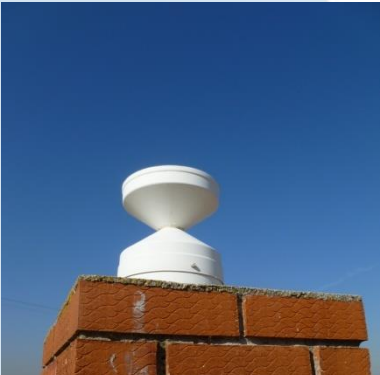
Precipitación Pluviómetros ARG100 y RM52203
