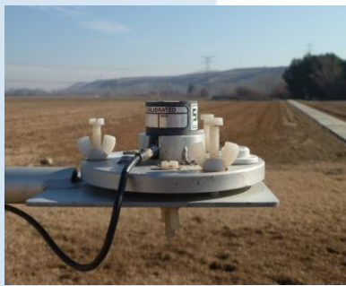
Radiación solar global Piranómetro SKYE SP1110
